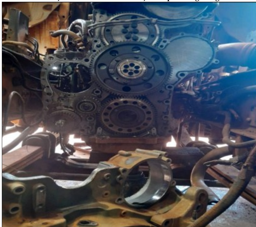
Figura 4 - Trem de engrenagens traseiro do virabrequim exposto, nesta condição realiza-se a substituição da polia/engrenagem traseira
