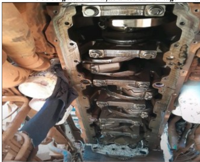
Figura 5 - Vista inferior do virabrequim e mancais principais com cárter removido, para inspeção dimensional e de desgaste/ovalização antes da montagem final
