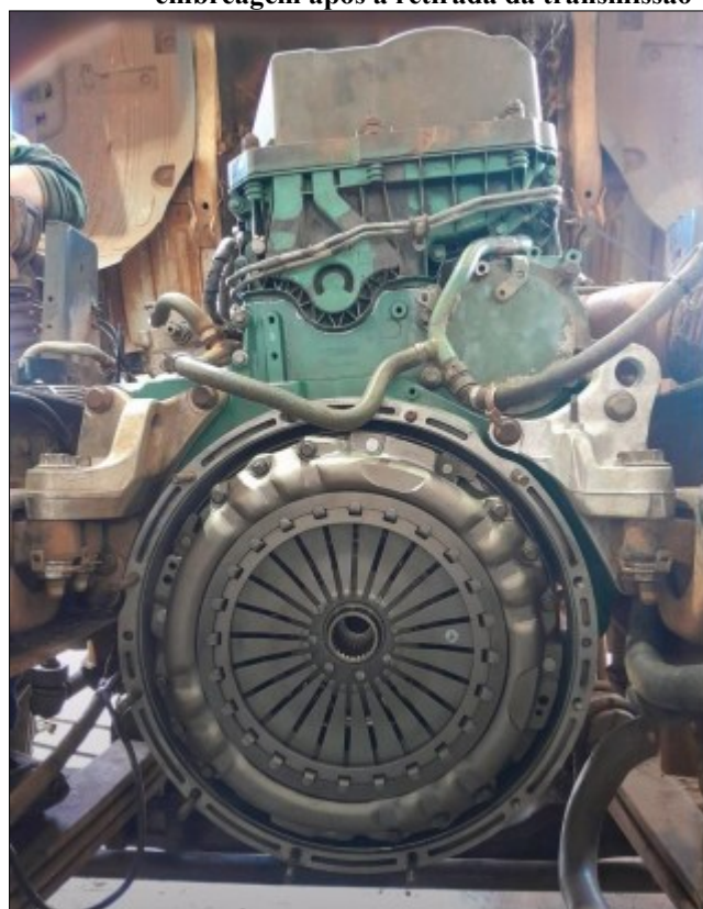
Figura 3 - Exposição do volante do motor e conjunto de embreagem após a retirada da transmissão
